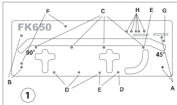
Stahlanschläge sind mit Gummiringen versehen, die Herausfallen der Anschläge aus Löchern verhindern. Metallanschlag mit Bolzen ins Loch einschieben, sodass er völlig eingeschoben ist. Falls die Metallanschläge schwer einzuschieben sind, Gummiringe mit Öl reiben. Vor Gebrauch immer überprüfen, ob die Anschläge völlig in Löchern eingeschoben sind. Vor Gebrauch ist ebenfalls zu überprüfen, ob die Anschläge Arbeitstisch nicht berühren.
