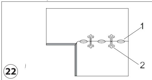
Vor Zusammensetzung der Platten Kanten mit Sandpapier leicht reiben. Klebstoff in Lamellenverbindungen auftragen. Wir empfehlen, für die ganze Verbindung wasserfesten Klebstoff oder Kitt zu verwenden. Zum Verbinden von beiden Küchenarbeitsplatten verwenden Sie Stahlgewindegazangen Länge 150 oder 65 mm (Gewindegazange mit 65 mm Länge seit dem 1.1.2011 verwendbar), mit denen die komplette Verbindung fest festgezogen wird.
