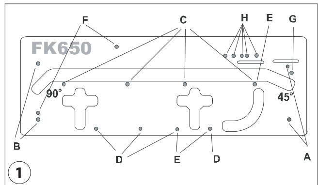
Ocelové dorazy jsou opatřeny gumovými kroužky, které brání vypadnutí dorazu z otvorů. Vložte kovový doraz čepem s gumovým kroužkem do otvoru tak, aby byl zcela zasunut. Pokud jdou kovové dorazy zasunout těžce, namažte olejem gumové kroužky. Před použitím se vždy přesvědčte, že jsou dorazy zcela zasunuty do otvorů. Před použitím zkонтrolujte, zda dorazy nejsou opřeny o pracovní stůl.
