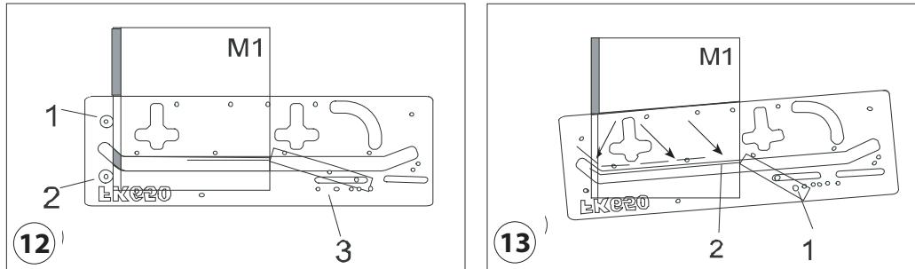
Šablonu upněte pomocí svěrek ke kuchyňské desce a prověřte, zda svěrky nebrání pohybu horní frézkou a zda je šablonu pevně upnuta ke kuchyňské desce. Posuvný doraz povolte a vyjměte, aby nedošlo k jeho poškození frézou. Nastavte hloubku řezu na horní frézce. Vložte horní frézku a začněte frézovat spoj několika průchody, zleva doprava. Kopírujte vzdálenější hranu šablony FK (obr. 13).
