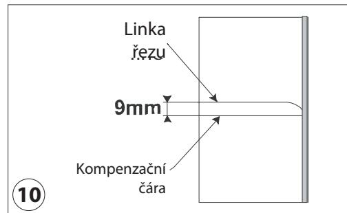
Vyjměte délkový posuvný doraz z otvoru. Vložte dva kovové dorazy do otvorů B z lícové strany FK a přiložte FK lícovou stranou dle (obr. 11) na desku M1 (která je otočená rubovou stranou nahoru). Nastavte vzdálenější hranu šablony FK (viz čáry) přesně podle zakreslené kompenzační čáry.
