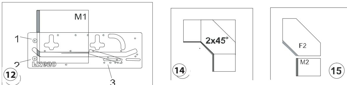
Teraz, za pomocą ścisków przymocuj FK do płyty kuchennej. Sprawdź, jeśli ściski w rowkach przyrządu nie będą w żaden sposób przeszkadzały frezarce górnoprzewodowej w pracy oraz jeśli szablon jest odpowiednio przymocowany do płyty kuchennej. Poluzuj przesuwany ogranicznik i wyjmij go, aby zapobiec jego uszkodzeniu. Na frezarce górnoprzewodowej ustawi odpowiednią głębokość cięcia.
