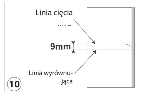
Z otworu wyciągnij przesuwny ogranicznik długości. Z przedniej strony szablonu FK włóż dwa metalowe ograniczniki w otwory oznaczone literą B, a następnie umieść szablon przednią stroną (patrz: rys. 11) na płytę M1 (odwróconą spodem do góry). Ustaw bardziej odległą krawędź szablonu FK (patrz linie) dokładnie według wcześniej narysowanej linii wyrównującej.
