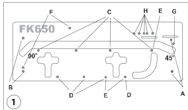
Az acél ütközők gumigyűrűkkel vannak ellátva, amelyek megakadályozzák az ütközők kiesését a nyílásokból. Helyezze a fém ütközőt csappal gumigyűrűvel a nyílásba úgy, hogy teljesen becsússzon. Ha nehezen csúsznak be a az ütközők, kenje meg a gumigyűrűt olajjal Használat előtt bizonyosodjon meg, hogy az ütközők teljesen be vannak tolva a nyílásokba. Használat előtt ellenőrizze, hogy az ütközők nincsenek-e nekitámasztva a munkaasztalnak.
