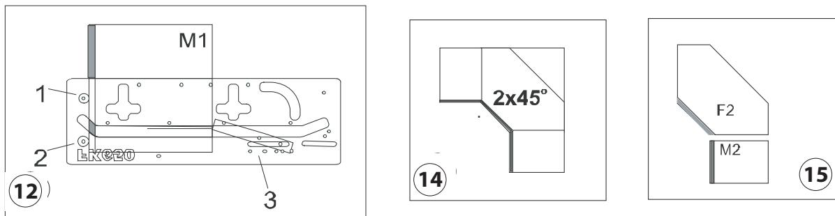
Šablónu upevnite pomocou svoriek ku kuchynskej doske a preverte, či svorky nebránia v pohybe hornou frézovačkou a či je šablóna pevne upnutá ku kuchynskej doske. Posuvný doraz povolte a vyberte, aby nedošlo k jeho poškodeniu frézou. Nastavte hĺbku rezu na hornej frézovačke. Vložte hornú frézovačku a začnite frézovať spoj niekoľkými priechodmi, z ľava do prava. Kopírujte vzdialenejšiu hranu šablóny FK (obr.12).
