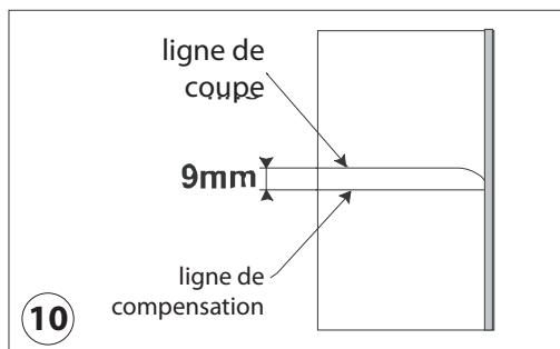
Enlevez l'arrêt coulissant du trou. Mettez deux arrêts métalliques dans des trous B à l'avers de FK et mettez l'avers du FK650 selon (fig. 11) sur le panneau M1 (qui est tourné par l'envers en haut). Ajustez l'arête distante du gabarit FK (voir flèches) justement d'après la ligne de compensation dessinée.
