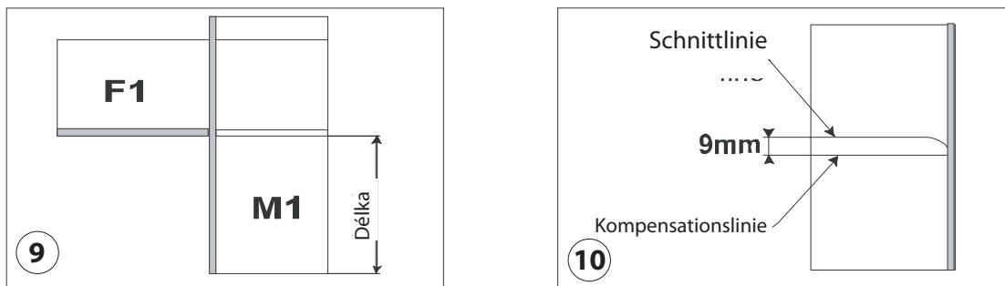
Längenschiebeanschlag aus dem Loch entnehmen. Auf Vorderseite von FK zwei Metallanschläge in B Löcher einschieben und FK mit der Vorderseite nach (Abb. 11) auf Platte M1 (die mit Rückseite nach oben gewendet ist) legen. Die entfernte Ecke der Schablone FK (siehe Pfeile) genau nach der gezeichneten Kompensationslinie einstellen.
