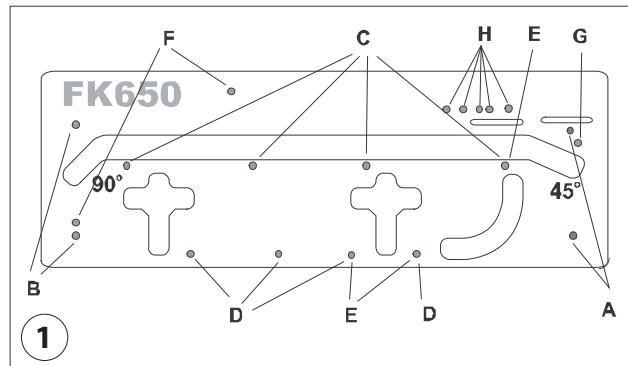
Oceľové dorazy majú gumené krúžky, ktoré bránia vypadnutiu dorazu z otvorov. Vložte kovový doraz čapom s gumeným krúžkom do otvoru tak, aby bol úplne zasunutý.
