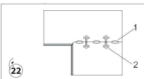
Avant de joindre les panneaux, meulez légèrement les bords de l'assemblage par le papier abrasif. Mettez de la colle dans des joints à lamelles. Nous recommandons d'utiliser de la colle ou du lut d'étanchéité à l'eau. Pour joindre les deux panneaux de cuisine, utilisez les serres en acier d'une longueur de 150 ou 65 mm (les serres de 65 mm utilisables à partir du 1.1.2011) qui vous permettent de complètement serrer l'assemblage.
