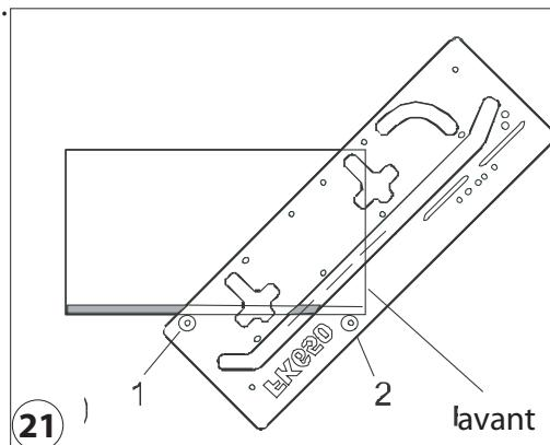
Mettez les arrêts métalliques dans les trous. Placez le gabarit FK par les arrêts à l'arête du panneau. Fixez le gabarit à l'aide des serres au panneau de cuisine et vérifiez si les serres n'empêchent pas la manipulation de la défonceuse. Réglez la profondeur de coupe de la défonceuse. Prenez la défonceuse et commencez à fraiser l'assemblage à plusieurs passages, du gauche à droit. Copiez selon l'arête intérieure du radius ou de la rainure.
