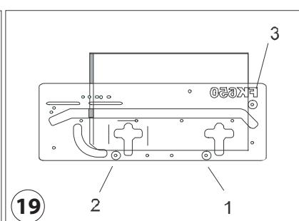
Zalecamy, aby otwory frezować, co najmniej 150 mm od postformingowej krawędzi. Na obu płytach na ich spodniej części zaznacz ołówkiem osie otworów. Jeśli używasz płyt o szerokości mniejszej niż 600 mm, musisz do każdego otworu odpowiednio dostosować szablon FK. W przypadku płyt o wymiarach 600-650 mm rozstaw otworów jest już ustalony na szablonie, a dzięki temu możesz równocześnie wyfrezować dwa otwory w jednym mocowaniu, ale pod warunkiem jeśli rozstaw jest dla Ciebie odpowiedni.
