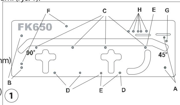
Stalowe ograniczniki wyposażone zostały w gumowe pierścienie, które zapobiegają wypadnięciu ogranicznika z otworów. Metalowy ogranicznik czopem zaopatrzonym gumowym pierścieniem włóż w otwór tak, aby był całkowicie wsunięty. Jeśli wystąpią problemy z zasunięciem metalowych ograniczników to w tym przypadku gumowe pierścienie należy nasmarować olejem. Przed użyciem, upewnij się, że ograniczniki są całkowicie wsunięte w otwory oraz że nie dotykają stołu roboczego.
