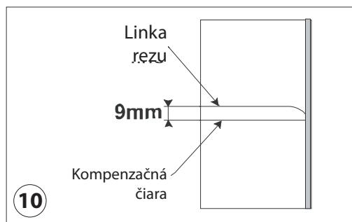
Vyberte dĺžkový posuvný doraz z otvoru. Vložte dva kovové dorazy do otvorov B z lícovej strany FK a priložte FK lícovou stranou podľa (obr.11) na dosku M1 (ktorá je otočená rubovou stranou hore). Nastavte vzdialenejšiu hranu šablóny FK (viz. šípky) presne podľa nakreslenej kompenzačnej čiary.
