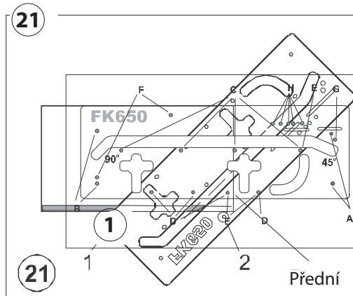
Vložte kovové dorazy do otvorů. Přiložte šablonu FK dorazy k hraně desky. Šablonu upněte pomocí svěrek ke kuchyňské desce a prověřte, zda svěrky nebrání pohybu horní frézkou. Nastavte hloubku řezu na horní frézce. Vložte horní frézku a začněte frézovat spoj několika průchody, zleva doprava. Kopírujte podle vnější hrany radiusu nebo drážky.
